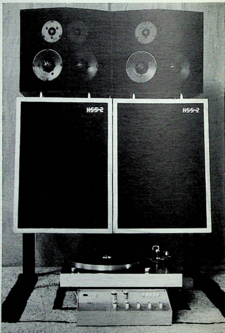
De HSS-2 compleet. De platenspeler is een Thorens TD145 mkII met Stanton-element 681 EEE en ingebouwde „Floria à la maison”.
